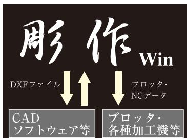
DXFファイル形式による入出力を搭載していますので、各種CADアプリケーションとの連携が可能です。またプロッタデータ、NCデータ出力により、様々なプロッタ、カッティングマシン、NC彫刻機・加工機、レーザー加工機等への出力が可能です。
