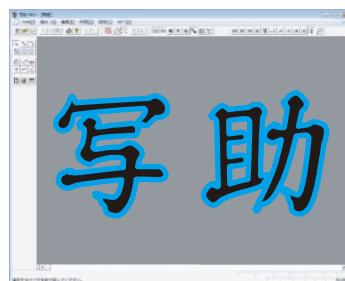
輪郭抽出ボタンを押して、マウスで画像を囲むだけで自動的に輪郭ベクトルデータを抽出します。直線(緑色の線)、円弧(水色の線)で非常に綺麗なベクトルデータの抽出が可能です。
