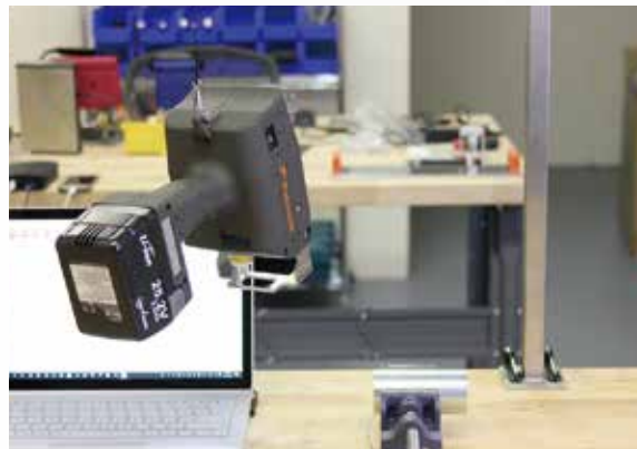
バランサーで吊るせるハンガーホールを装備
