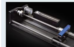
グラス、マグ、花瓶、ワインボトル、などの円柱に彫刻できる操作が簡単なロータリーアタッチメントです。使いやすいデザインで数秒でセットできます。両側から角度を調整し固定できるので、すれにくい構造になっています。
