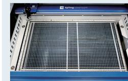
アクリルや木材、紙などの切断加工などに最適な加工テーブルオプションです。アルミ製のグリッド(十字枠)の上で切断加工をする事により、余分なレーザー光による材料の損傷を防ぎ、切断品質を向上させます。また、切断作業の際に出てくる埃や煙を、材料下部のテーブル内部からも排煙させることができ、材料やシステムに対する埃や煙によるダメージを防ぎます。
