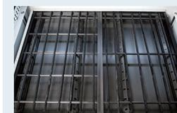
切断する材料と作業テーブルの間の接触点を大幅に減らし、大きな材料や厚みのある材料に対して少ない面積で支える事で、材料に対するレーザーの反射ダメージを防ぎます。ベクターグリッドと比較すると大きな切り出し作業に向いています。
