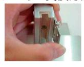
前面の金具を開きプラスドライバー でネジを緩めて下さい。
