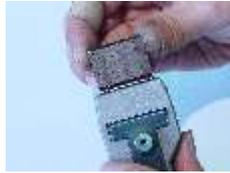
刻印の溝をネジ側に揃えて入れて下さい。
