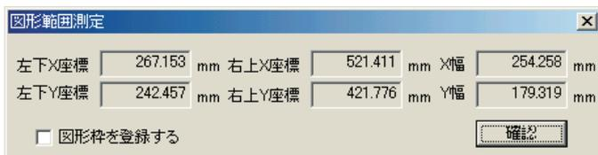
図形全体に四角枠を一時的に作成し、領域の寸法を表示します。
