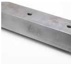
熱処理材 (HRC62) への打刻
